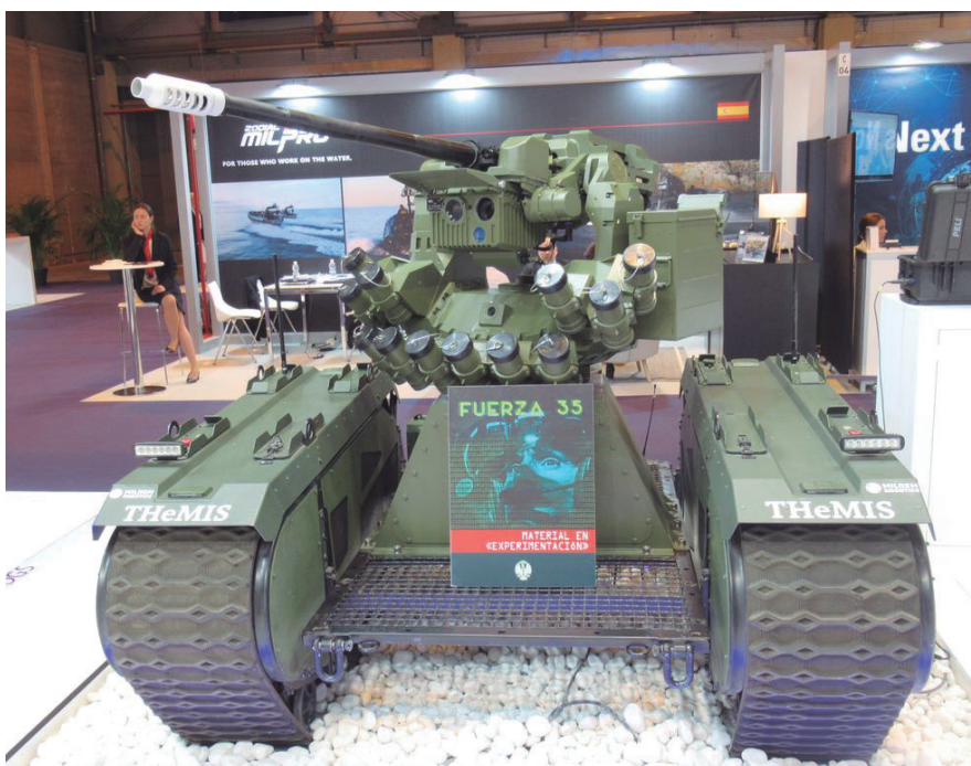
El TheMIS de Mirem con la torre Guardian 2.0 y el cañón M230 (foto JM Navarro).
