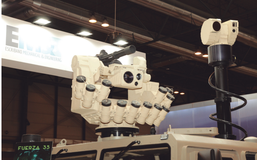
Sistema SCOA formado por sensor OTEOS y torre Guardian 2.0 (foto EM&E).
