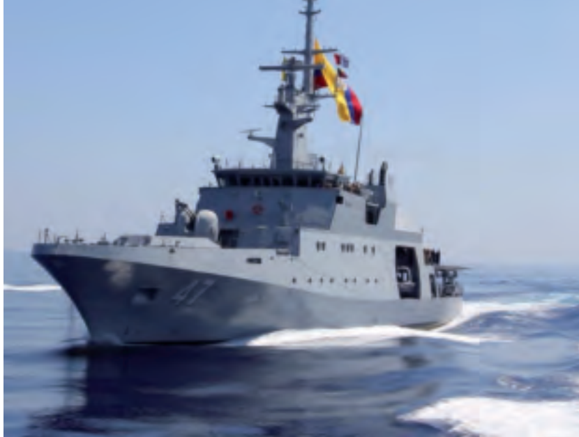
PZE 47 ARC 7 de Agosto: Su arma principal es el cañón Twin 40L-70 bitubo de 40 mm. (foto Armada de Colombia).
