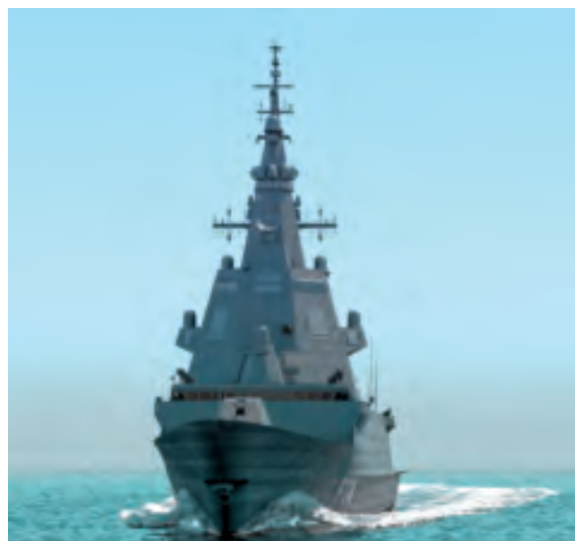
La mayoría de sensores clave de la F-110 se alojan en la superestructura piramidal sobre el puente (foto Indra).
