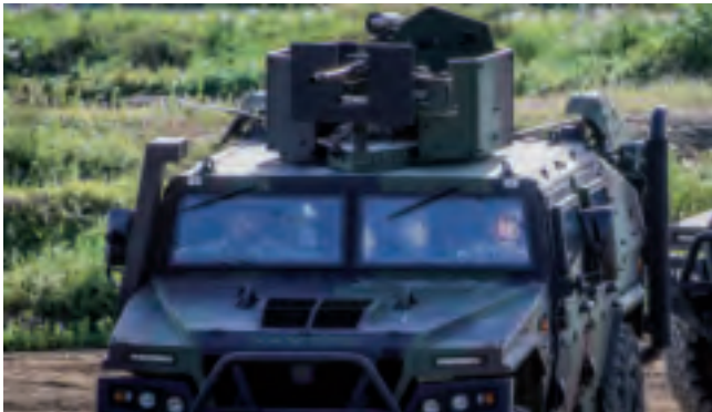
En esta imagen se aprecian los elementos visibles de la preparación, como el "snorkel" y el tubo de escape (Armada)
